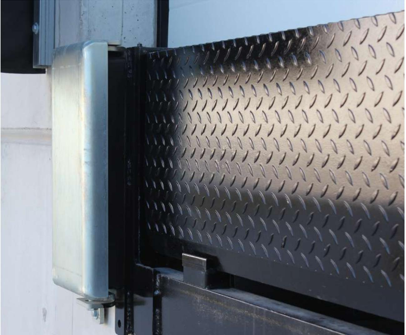
El **tope de acero** se compone de una superficie de chapa de acero de 12 mm que contiene en su interior 2 topes de goma independientes uno del otro, favoreciendo así la **máxima estabilidad y seguridad** en el momento de contacto del camión.
