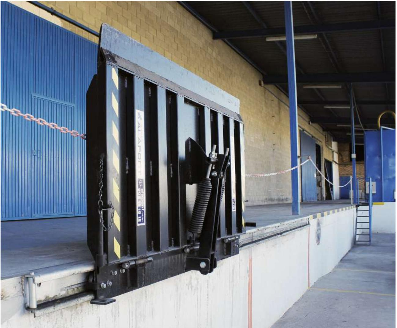
Las pasarelas de acero se utilizan para **salvaguardar el desnivel entre el almacén y el camión de forma manual** y sin ningún tipo de esfuerzo. Tienen un precio inferior a las rampas hidráulicas o muelles de carga hidráulicos al **no requerir la construcción de un foso**.
